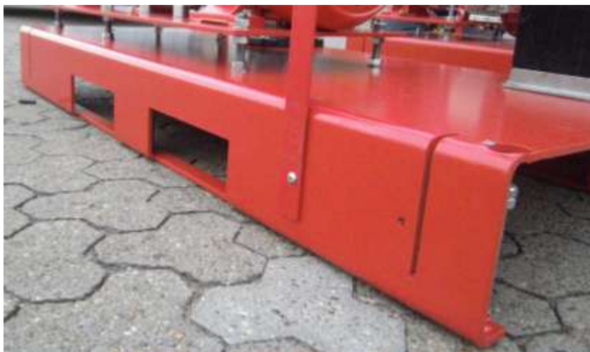
Figur I: Transport af sprinkleranlæg, I) Løfteøjer
